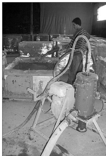
**Рис. 3.** Фрагмент цеха по производству легкого пенобетона методом «обжатие-релаксация»
